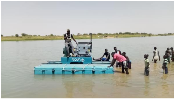
Illustration 1 : Exemple d'une motopompe immergée (Source : Irritec Sénégal)
