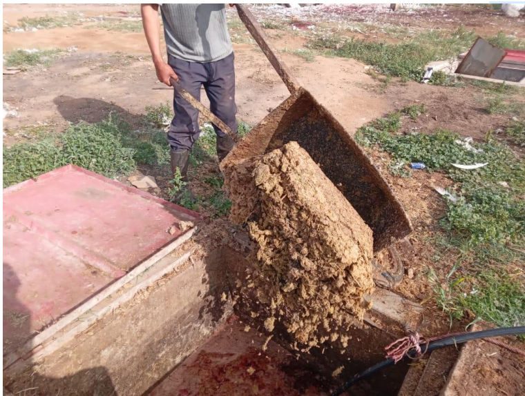
Photos de remplissage de cuve de biogaz par les déchets de l'abattoir pour la production du gaz.
