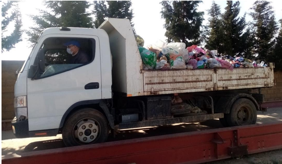
Camion de collecte de la commune pesé sur le pont-bascule (chargement de 1t94)
